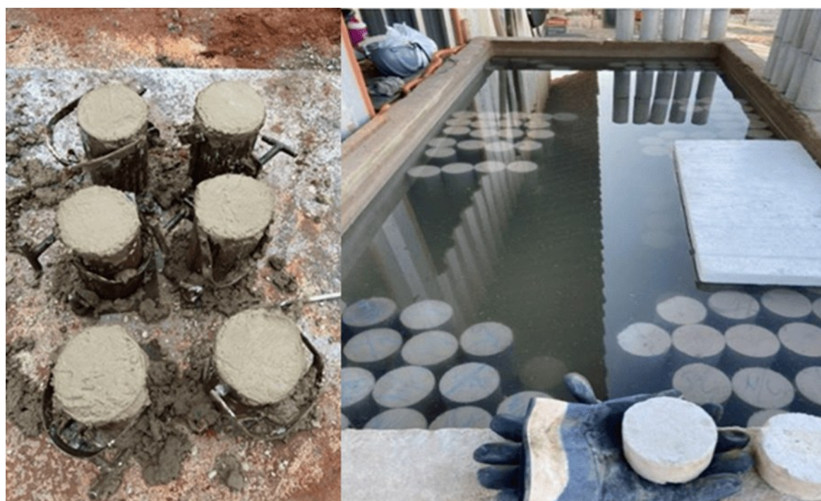
Figura 2. Corpo de prova, moldado conforme as normas NBR 5738 (ABNT, 2015) e NBR 5739 (ABNT, 2018), separado para teste de compressão. Fonte: Santos et al. (2025).
