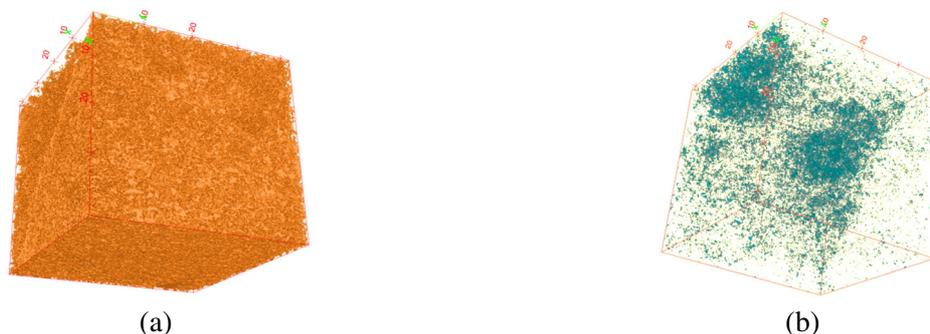
Figura 1. Imagem em 3D do espaço poroso inter-agregados e intra-agregados do Neossolo Regolítico Eutrófico (a-b).
