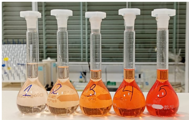
Figura 2: Exemplo de padrões preparados para curva de calibração de Ferro II
